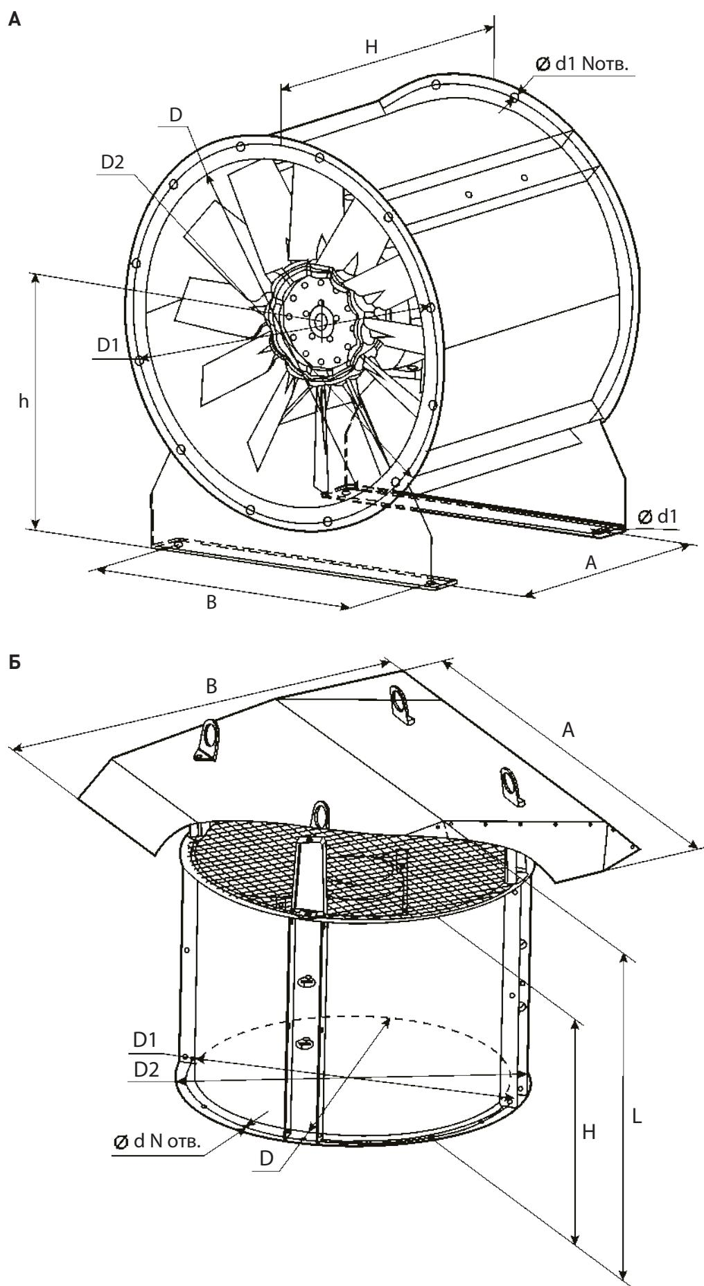
**Рисунок 1.** Осевой вентилятор: А – на монтажных опорах; Б – с крышкой
