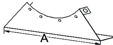
**Рисунок 11.** Опора вентилятора
