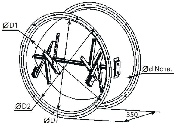
Рисунок 9. Клапан обратный круглый
