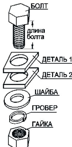
**Рисунок 12.** Соединение фланцев
