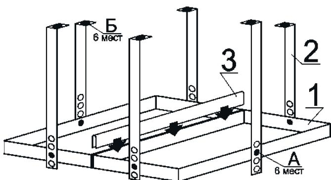
**Рисунок 17.** Монтаж поддона
