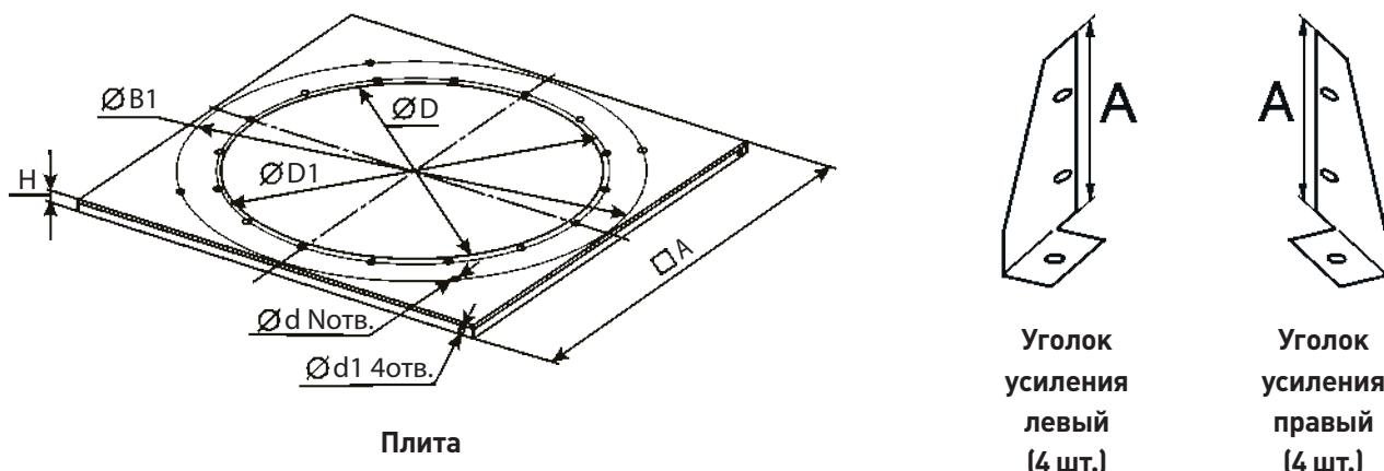
Рисунок 7. Плита опорная (слева), уголки усиления (справа)
