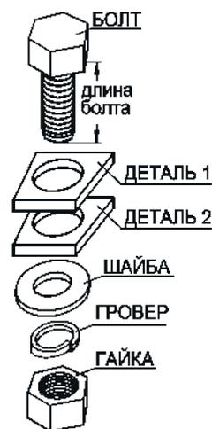
Рисунок 12. Соединение фланцев
