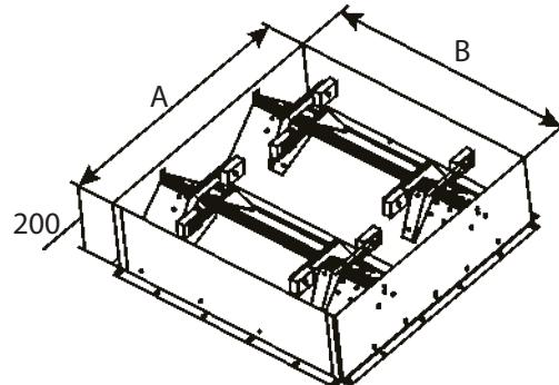
**Рисунок 3.** Обратный клапан
