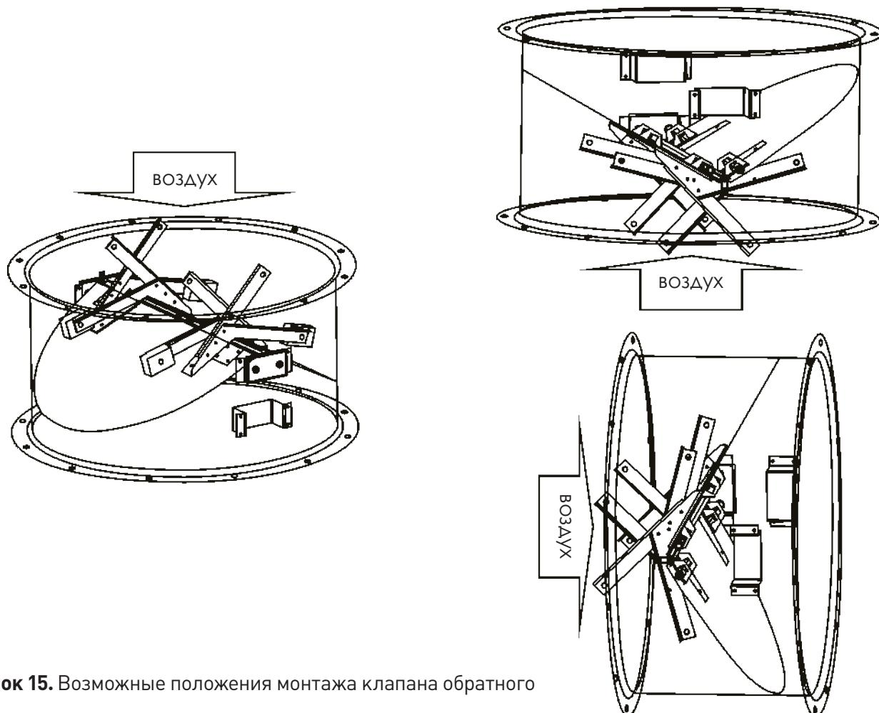
**Рисунок 15.** Возможные положения монтажа клапана обратного
